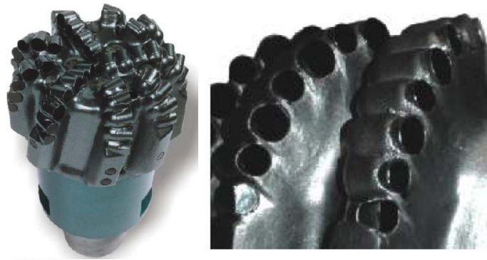
Figura 17: ARCS™ Bit (sinistra) ed un particolare della struttura tagliente (destra).
