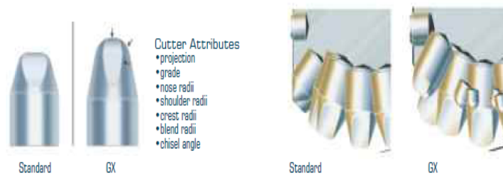
Figura 11: Forma (a sinistra) e posizione (a destra) dei taglienti nello scalpello GX^{TM} .
