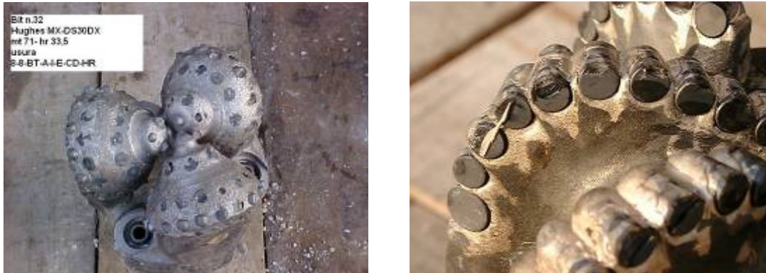
Figura 80: Usura negli scalpelli a rulli e PDC (Eni S.p.A., Divisione E&P).
