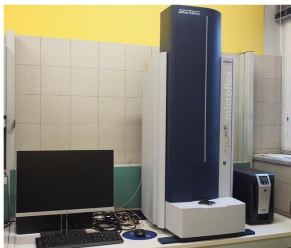
Figura 39. MALDI-TOF-MS: strumento utilizzato e rappresentazione schematica del suo funzionamento
