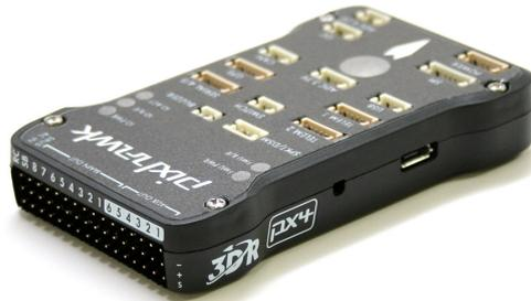
FIGURE 3.2: Pixhawk<sup>®</sup> FMU main module.
