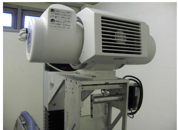
Fig. 2 A sinistra, una vista da dietro di MECT, in cui si intravede la sala di controllo. A destra un particolare del tubo radiogeno e del cristallo monochromatore in grafite pirolitica altamente orientata (HOPG) con il supporto motorizzato.
