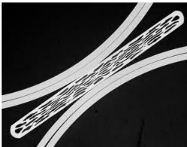
Figura 3.4: Sezione di un nastro BiSCCO_{2223} 1G HTS
