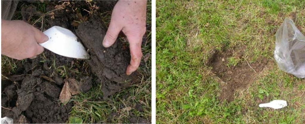
*Fig.2.2 Pulitura del campione di suolo mediante spatola polietilenica ed impacchettamento dei campioni per le analisi di laboratorio.*
