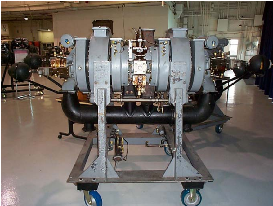
Figura 17 PT1 generatore di gas a pistoni liberi
