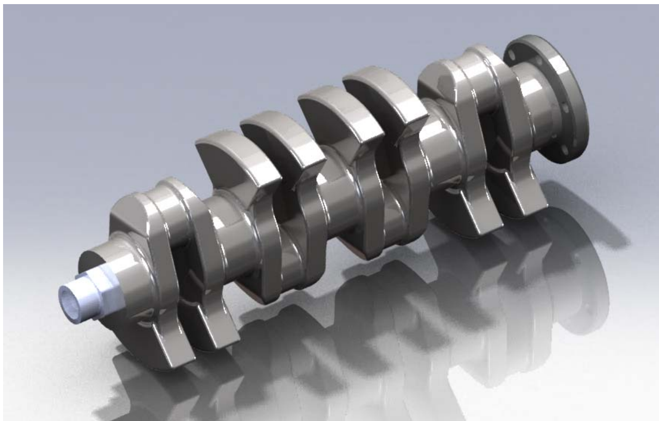
Figura 132 Albero motore relativo alla configurazione 3 (massa 11.95 kg)
