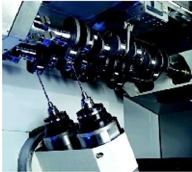
Figura 67 Foratura perni di manovella
