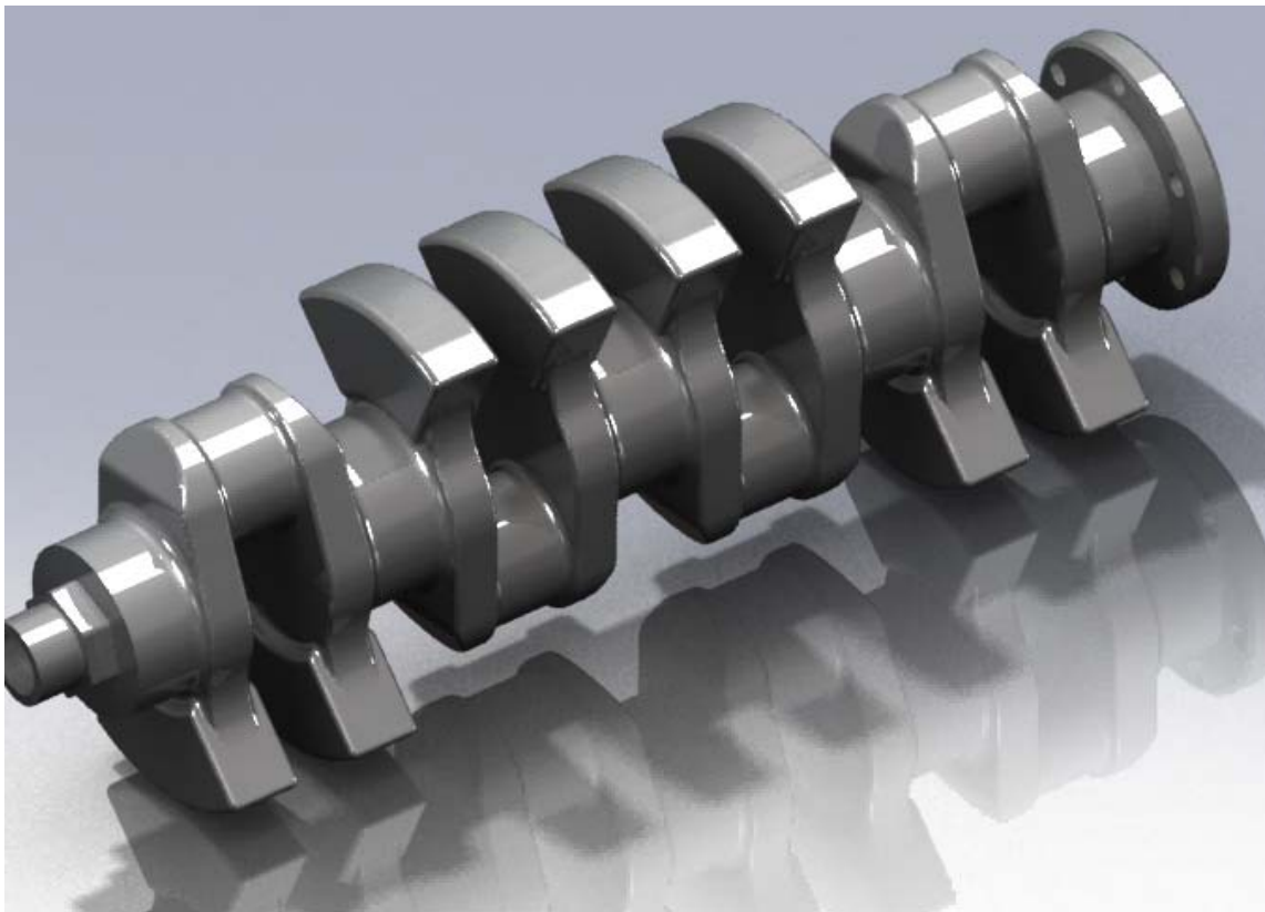
Figura 130 Albero motore relativo alla configurazione 2 (massa 12.12 kg)
