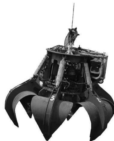
Figura 21. Immagine della benna mordente del tipo orange peel a cui è associato un sistema di ripresa video; lo strumento è stato impiegato per il campionamento dei materiali grossolani.
