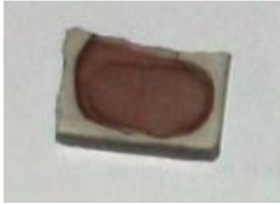
Figura 7.50 – Immagini della piastrella smaltata con frittta C1 e trattate a 550°C in atmosfera inerte/riducente.
