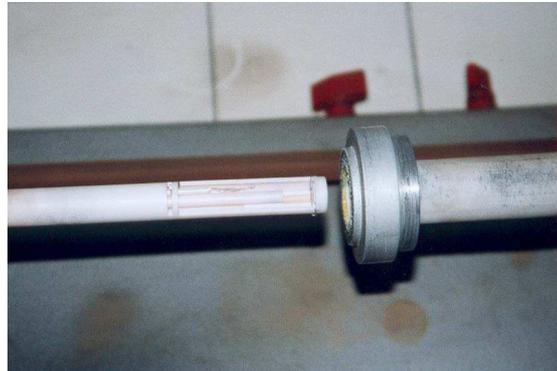
Figura 1. Dilatometro Netzsch 402E: particolare dell'asta con il campione
