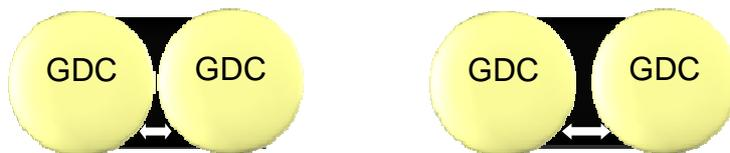
Figura 11. Schematizzazione di due particelle separate dal film amorfo a diverso spessore.
